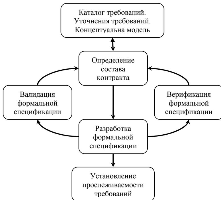
Рисунок 13. Отображение процесса построения формальной модели на Ф-процесс
