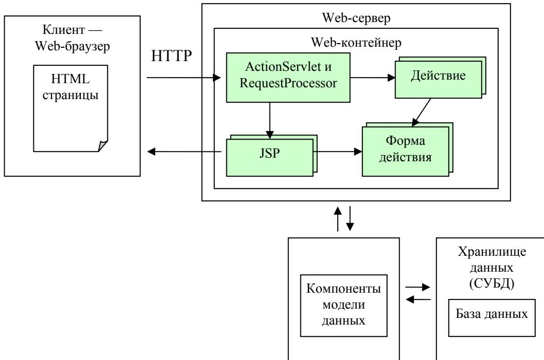
**Рисунок 79. Общая схема архитектуры Web-приложений на основе Struts.**
