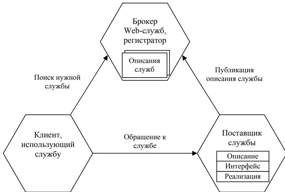
Рисунок 81. Схема архитектуры приложений на основе Web-служб.
